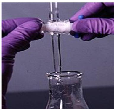
Usted verá el cambio de color del indicador cuando el titulante se mezcla gota a gota a la solución en el frasco, este cambio de color desaparece al agitar.
